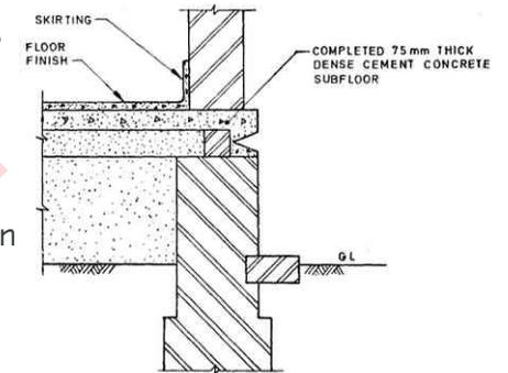
FIG. 6 ANTI-TERMITE CONSTRUCTION — STAGE 6
